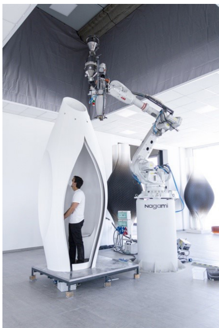
Рис. 8. Изделие из полимерных отходов, изготовленное методом 3D-печати [9]
